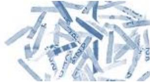
Datos altamente sensibles y confidenciales, así como los datos personales que sean objeto de altos requisitos de protección. Partículas de material con una superficie  $< 800 \text{ mm}^2$  y regulares con ancho máximo de corte de  $< 6 \text{ mm}$
