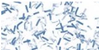
Datos confidenciales con medidas de seguridad extraordinarias. Partículas de material con una superficie  $< 30 \text{ mm}^2$  y regulares con ancho de tira  $< 2 \text{ mm}$
